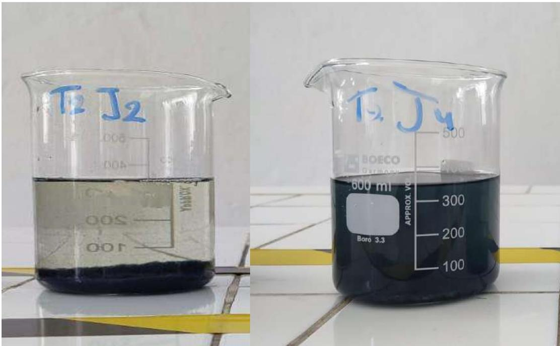
**Figura 8. A)** Tratamiento del agua residual con una dosificación de 1.12 g de Policloruro de Aluminio/L de agua a tratar **B)** Agua Previo tratamiento.
